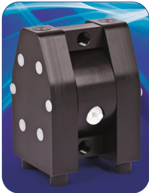
Использование при производстве пластиковых насосов токопроводящих PE и PTFE дает возможность заземления неметаллических насосов. Данное свойство позволяет безопасно использовать данные насосы для перекачивания растворителей, спиртов и других легковоспламеняющихся и взрывопожароопасных продуктов без риска возникновения искры от статического электричества. Этим свойством обладают, также, и насосы, изготовленные из алюминия, чугуна и нержавеющей стали.
