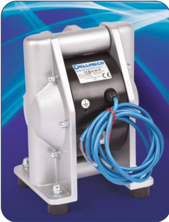
В данной версии в насос устанавливается индуктивный датчик, который реагирует на приближение мембраны что, таким образом, дает возможность осуществлять контроль за количеством тактов, сделанных насосом. Датчик устанавливается в центральный блок с внутренней (нерабочей) стороны мембраны и не контактирует с перекачиваемым продуктом. Выходящий от датчика сигнал может быть обработан контроллером и счетчиком тактов для возможности автоматического управления работой насоса.
