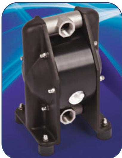
Версия с алюминиевыми корпусами с покрытием PTFE. Является альтернативой насосам, изготовленным из нержавеющей стали. Материал патрубков: нержавеющая сталь AISI 316. Чаще всего применяется для перекачивания красок и чернил.
