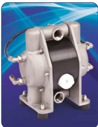
Насос с рубашкой обогрева. Рубашка используется в случае необходимости поддерживать температуру (высокую или низкую) в процессе перекачивания. Обогревающая или охлаждающая жидкость постоянно циркулирует через рубашку, расположенную снаружи, с противоположной стороны от контактирующих с перекачиваемым продуктом поверхностей насоса. Данная опция применяется для всех типоразмеров насосов из нержавеющей стали.
