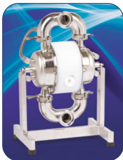
Насос с рубашкой обогрева. Рубашка используется в случае необходимости поддерживать температуру (высокую или низкую) в процессе перекачивания. Обогревающая или охлаждающая жидкость постоянно циркулирует через рубашку, расположенную снаружи, с противоположной стороны от контактирующих с перекачиваемым продуктом поверхностей насоса. Данная опция применяется для всех типоразмеров гигиенических насосов.
