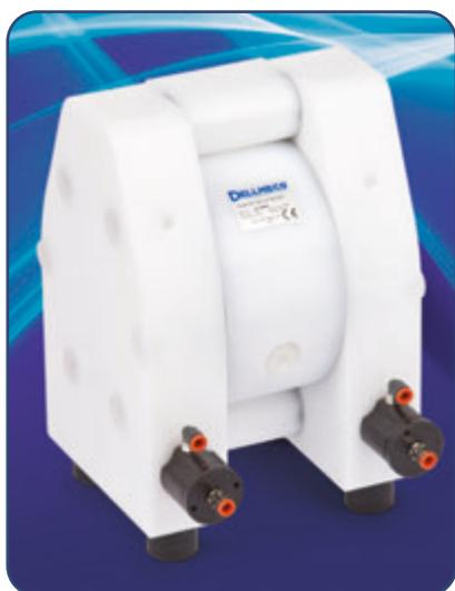
В данной версии в насос устанавливаются устройства с пневматическим приводом (опции BF4 и BF5), с помощью которых можно поднять клапаны насоса. Это дает возможность слива перекачиваемого продукта из насоса. Для этого необходимо во время работы насоса повернуть примерно на 10 мм влево клапан системы слива (не поворачивая клапан полностью во избежание полной блокировки клапанов насоса). Затем можно постепенно снижать скорость работы насоса до полной остановки.
